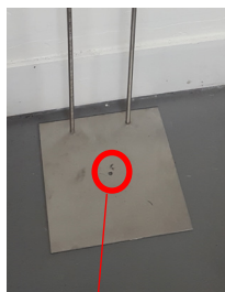
Schraubpunkte für die Wandbefestigung
