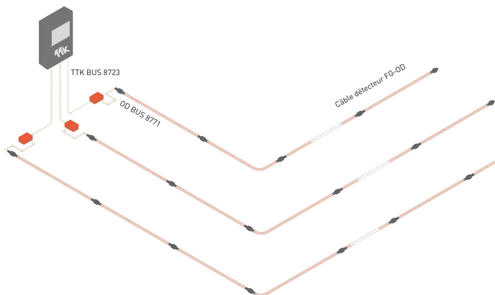
Figure 1.4.5.2: Installation de la centrale numérique FG-NET et du câble détecteur FG-OD utilisant des boîtiers d'interface FG-DOD
