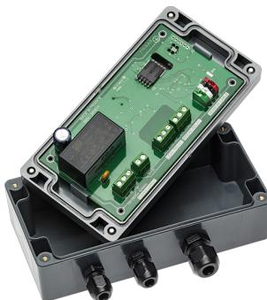
**Vorsicht: Alle Anschlüsse am Anschlussblock sind im spannungslosen Zustand der FG-A Alarmeinheit auszuführen.**
